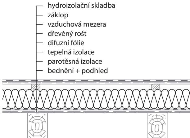
Obr. č. 7 - Dvouplášťová střecha s viditelnými trámy.
