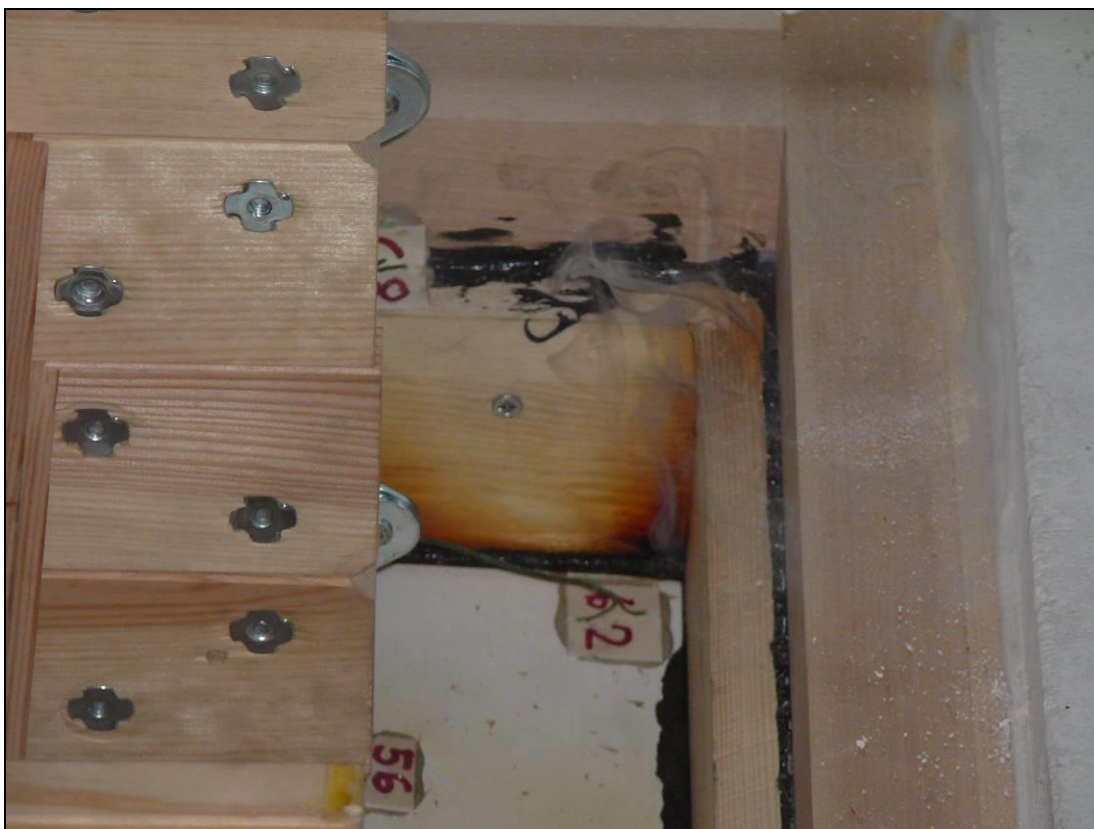
Vzorek č. 2 – napěňování pásy ve spáře – 20. minuta
