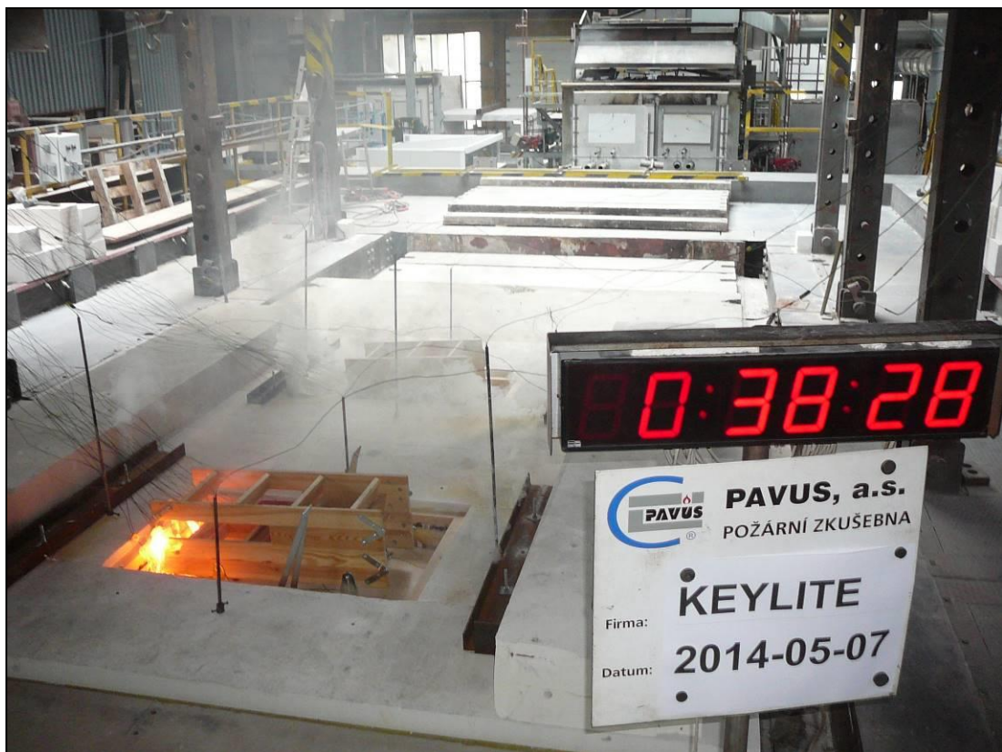
Konec zkoušky, porušení celistvosti vzorku č. 2 – 39. minuta
