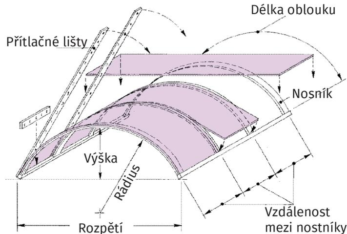
studena se vypočítá dle vzorce  $150 \times \text{tloušťka materiálu v mm}$
