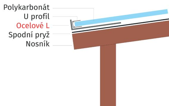
Otvor pro šroub by měl mít průměr dle vzorce: (průměr šroubu v mm + 4) × šíře nebo délka desky v metrech (větší z těchto dvou údajů). U velkých desek dokonce doporučujeme vyvrtávat podlouhlé otvory. Vzdálenost mezi středem otvoru a vnějším okrajem desky musí být nejméně dvojnásobek průměru otvoru (minimálně ale 6 mm).
