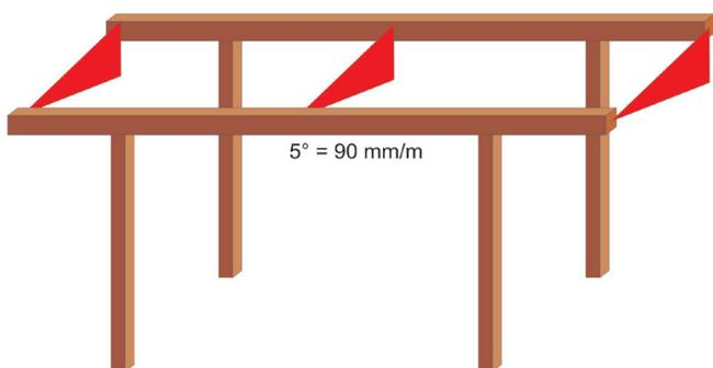
Sklon střechy musí být min. 5° (90 mm/m), aby byl zajištěn odtok dešťové vody a spolehlivost těsnění včetně samočisticího efektu desek dešťovou vodou.
