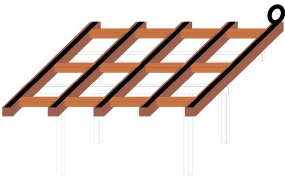
V prvním kroku opatřete kontaktní plochy nosné konstrukce plochým EPDM těsněním šíře 60 mm, které ke konstrukci připevníte odpovídajícím způsobem (například sponkovačkou k dřevěné a vhodným lepidlem ke kovové konstrukci).
