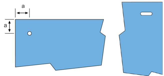
Šrouby by měly být utaženy pouze tak, aby se polykarbonátová deska měla možnost při vystavení teplotnímu namáhání volně roztahovat nebo smršťovat. Vyhněte se šroubům se zapuštěnými hlavami, které mohou způsobit praskání PC desek. Používejte jen šrouby s rovnou dosedací plochou.
