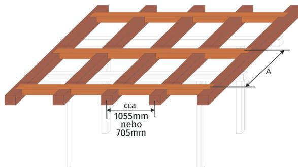
Z důvodu snazší manipulace a montáže doporučujeme desky nařezat na šíři 700 mm resp. 1050 mm.
