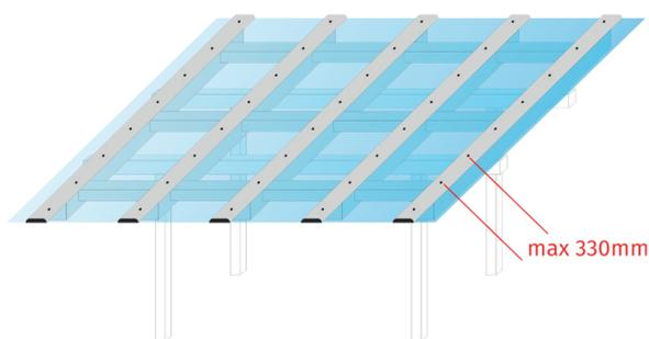
Hliníkové krycí lišty je možné doplnit z pohledové strany plastovou krytkou. Polykarbonát je nutné k nosné konstrukci přišroubovat, aby např. vlivem dilatace a pohybu po konstrukci desky nesjížděly dolů. Pokud instalujete desky široké jen přes 1 pole, je vhodné zajistit posun směrem dolů např. ocelovým L.
