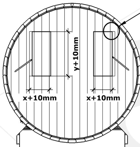
Při řezání okenních otvorů postupujte dle pokynů
